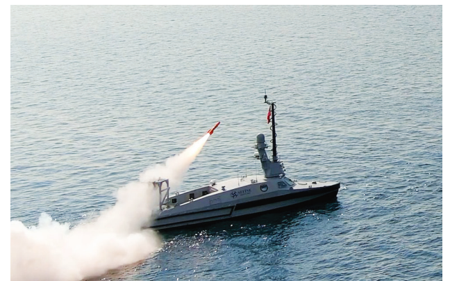
Το θαλάσσιο drone επιφανείας «Marlin» (είδος μεγάλου ψαριού) αποτελεί ένα από πιο σύγχρονα οπτικά συστήματα του Τουρκικού Ναυτικού. Είναι πολλαπλών επιχειρησιακών δυνατοτήτων, από τον εντοπισμό ναρκών ως τη συλλογή πληροφοριών, αναγνώριση στόχων και εκτόξευση πυραύλων.
