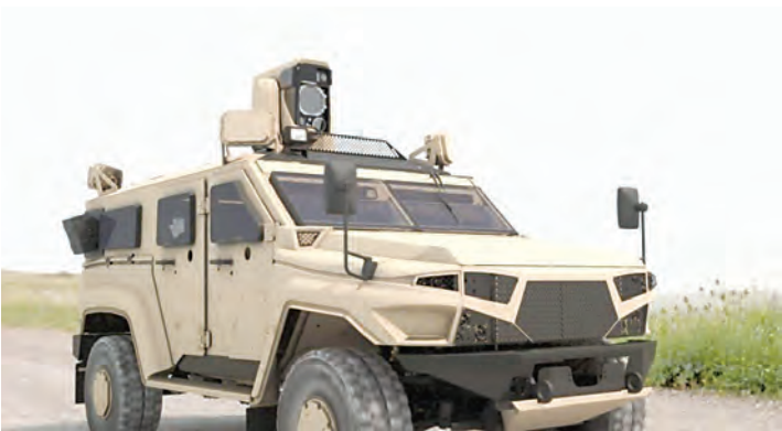
Το LITE BEAM τοποθετημένο σε θωρακισμένο όχημα, η μονάδα λέιζερ και σε έκθεση αμυντικής βιομηχανίας. Το σύστημα προορίζεται κυρίως για την αντιμετώπιση drones σε αποστάσεις περίπου 2-3 χιλιομέτρων, ανάλογα με τη διαμόρφωση και τις συνθήκες.
